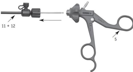
Rodar a ponta do instrumento (12) para fora da bainha (11) (o que pode exigir alguma força). A rosca está localizada na extremidade distal.
