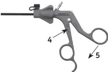
Fechar o punho do instrumento aplicando alguma força no manipulador (5) até a ponta do instrumento encaixar de forma audível.
