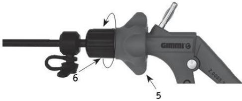
Abrir a porca de fixação (6) mantendo o botão rotativo (5) em posição e puxar a bainha com o instrumento inserido. Não impedir o movimento do manipulador móvel (4).
