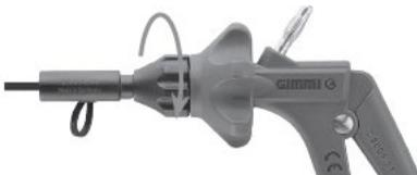
Apertar a porca de fixação **(03)**, segurando o botão rotativo **(04)**. Verificar o funcionamento do instrumento, antes de utilizar.
