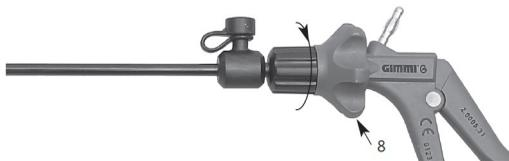
Apertar completamente a porca de fixação (9) com a mão, mantendo o botão rotativo (8) fixo.
