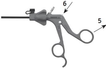
Pressionar o pino de segurança (6) no braço da pega móvel (5) e **simultaneamente abrir completamente a pega do instrumento** (aplicando alguma força) a fim de libertar a inserção do instrumento do seu mecanismo de encaixe.
