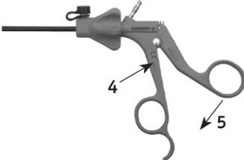
Fechar o punho do instrumento aplicando alguma força ao braço (5) até que a inserção do instrumento se encaixe audivelmente.
