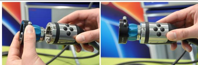
Conexión del adaptador de TV a un endoscopio
