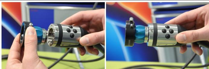
Connexion d'un adaptateur TV à un endoscope
